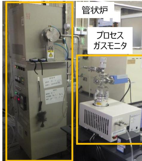
図5 管状炉およびガス分析計
